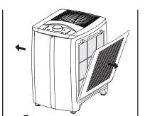
② 打开左右两侧过滤器盖: 过滤器盖由上方两侧位置 往外侧拉出
