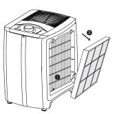
5 沿两侧滑槽,向外上提 后取出高效滤器
