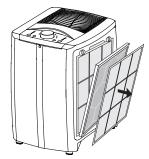
3 取出初过滤器及分子滤器 (新机过滤器需取下塑料袋)
